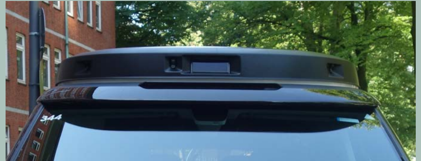
Ein autonomes Taxi in Hamburg: Kameras und Sensoren auf dem Dach des VOLKSWAGEN-Fahrzeugs überwachen und steuern ständig seine Fahrt.
