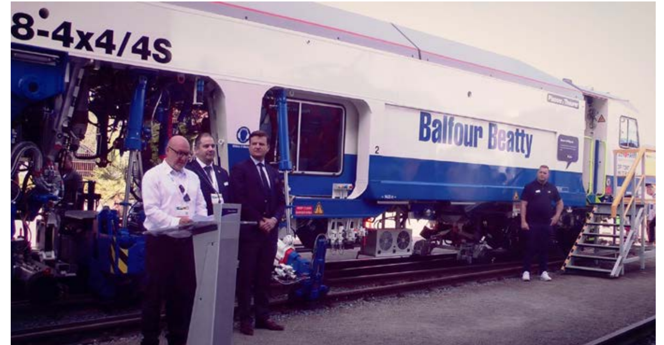
Der rechte Teil der neuen Maschine für Großbritannien, von denen der Gleisbauer Balfour Beatty (BB) insgesamt vier Exemplare erhält. Im Zentrum steht das weltweit bewährte 4x4-Stopfaggregat mit schwenkbarer Aufhängung, seitlicher Bewegung dank Teleskopführungsstangen, Split-Head-Technologie und schwenkbaren Stopfpickeln. Dieses Stopfaggregat mit Elektroantrieb ist ab sofort optional für den Plasser Unimat 4x4e mit Verbrennungsmotor erhältlich.
