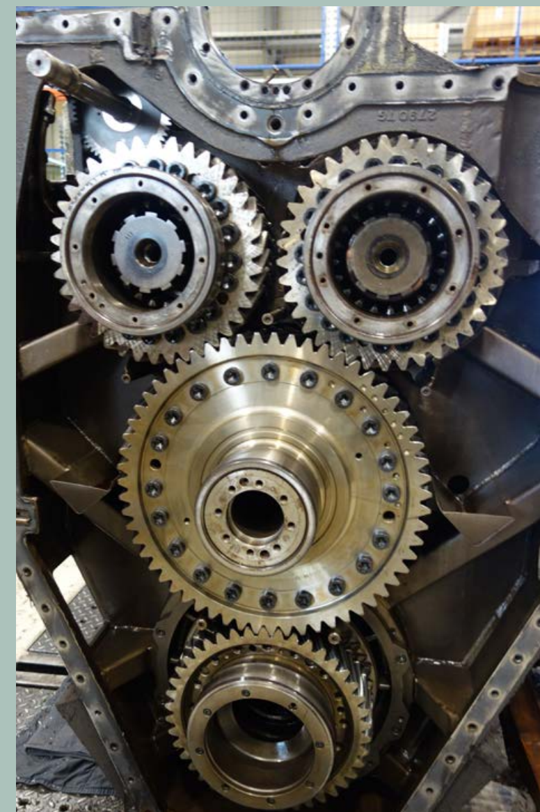
Schwere Brocken präzise auf Pass: Blick in ein Großgetriebe während der Aufarbeitung.
