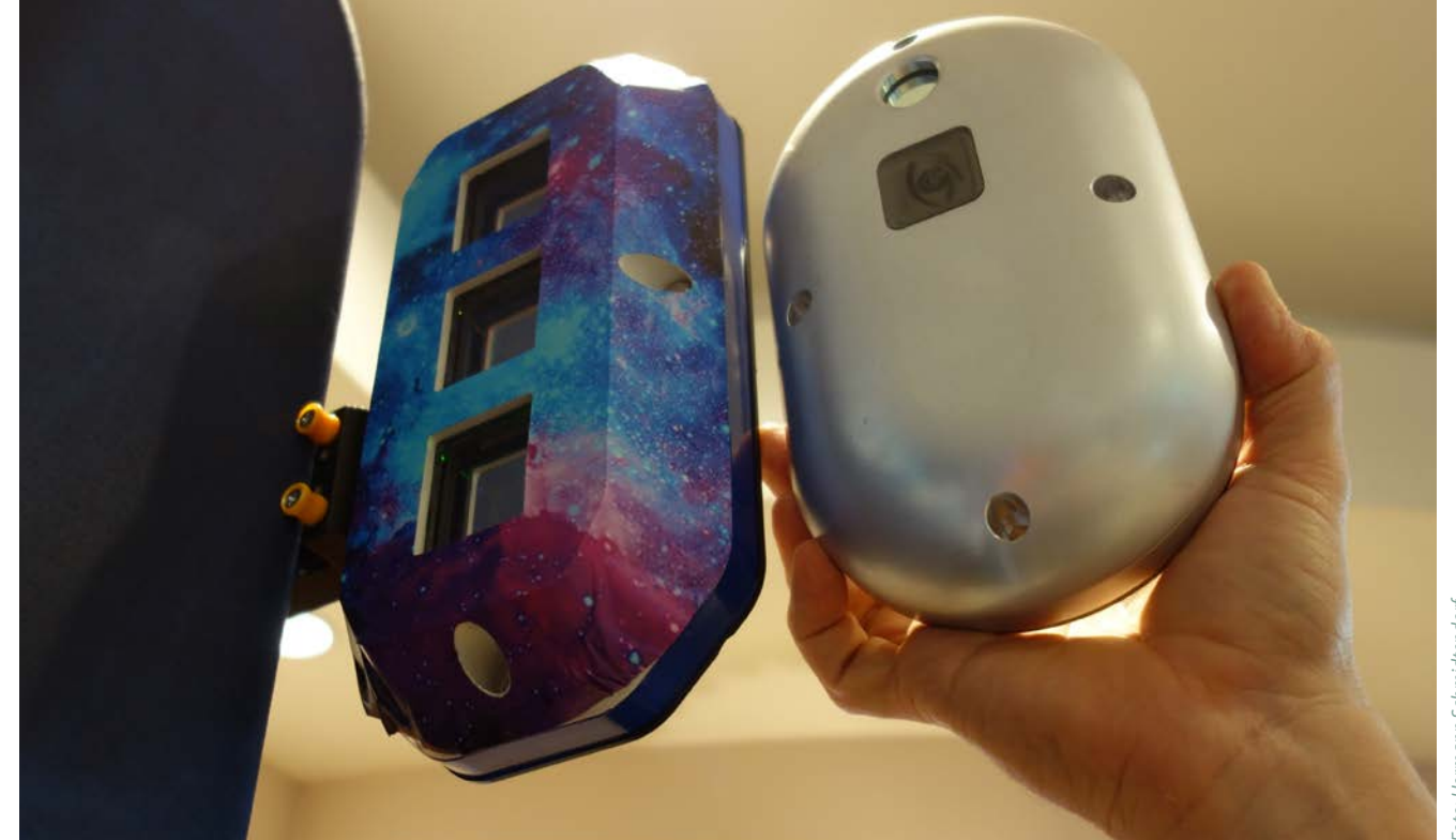
Der stationäre Empfänger (links) und der am Zug befestigte mobile Sender tauschen ultraschnell Daten aus – mit Infrarot.
