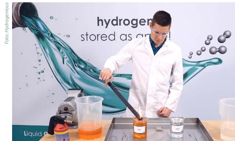
Na sowas, da brennt ja nichts! Ein Techniker von Hydrogenious demonstriert, wie sicher das Träger-LOHC be- und entladen ist.
