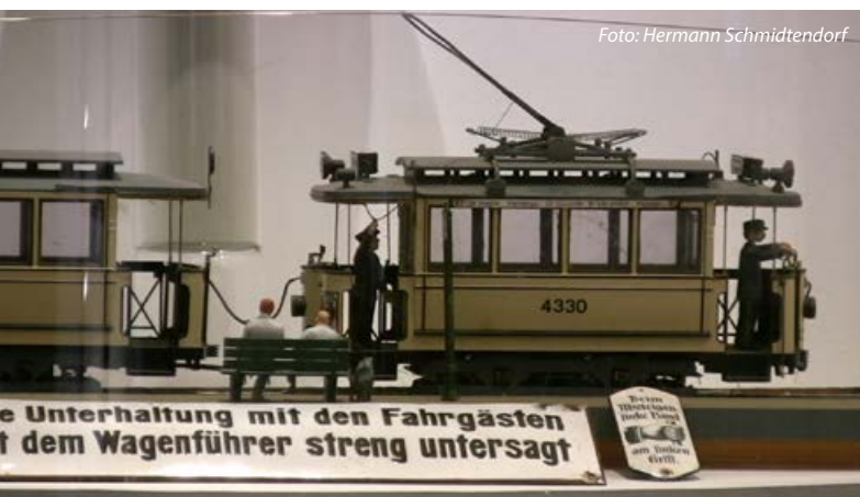
Modell einer ersten Siemens-Straßenbahn mit dem Reichel'schen Bügel.
