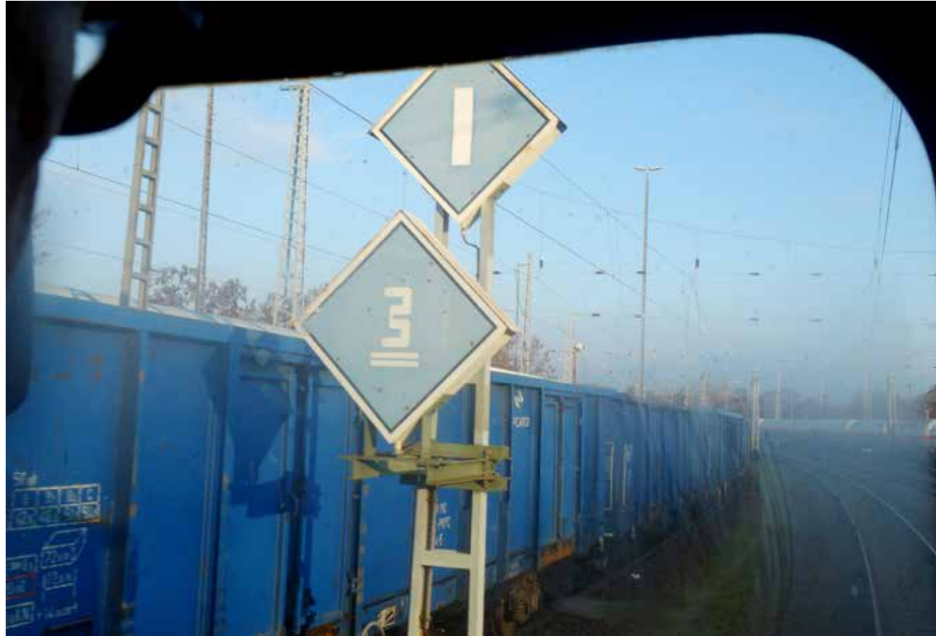
Blick aus einer Lokomotive am deutschen Grenzbahnhof zu Polen Frankfurt Oderbrücke auf die Streckensignale. Die Signale besagen: Der Pantograph für den polnischen Bahnstrom muss hochgefahren werden, für Bahnstrom 3000 Volt Gleichstrom. View from a locomotive at the German border station with Poland Frankfurt Oderbrücke on the track signals. The signals say: The pantograph for the Polish traction current must be started, for traction current 3000 volts direct current. Credits: Hermann Schmidtendorf
