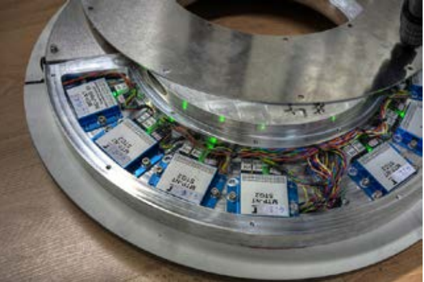
The special feature is inside: a measuring wheelset from PJM. La particolarità all'interno: un set di ruote di misurazione PJM.
