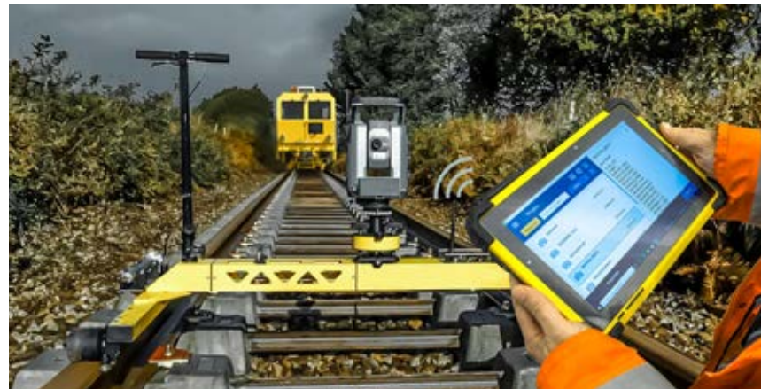
A MATS station for guidance with absolute geometry. Una stazione MATS per la guida con geometria assoluta.
