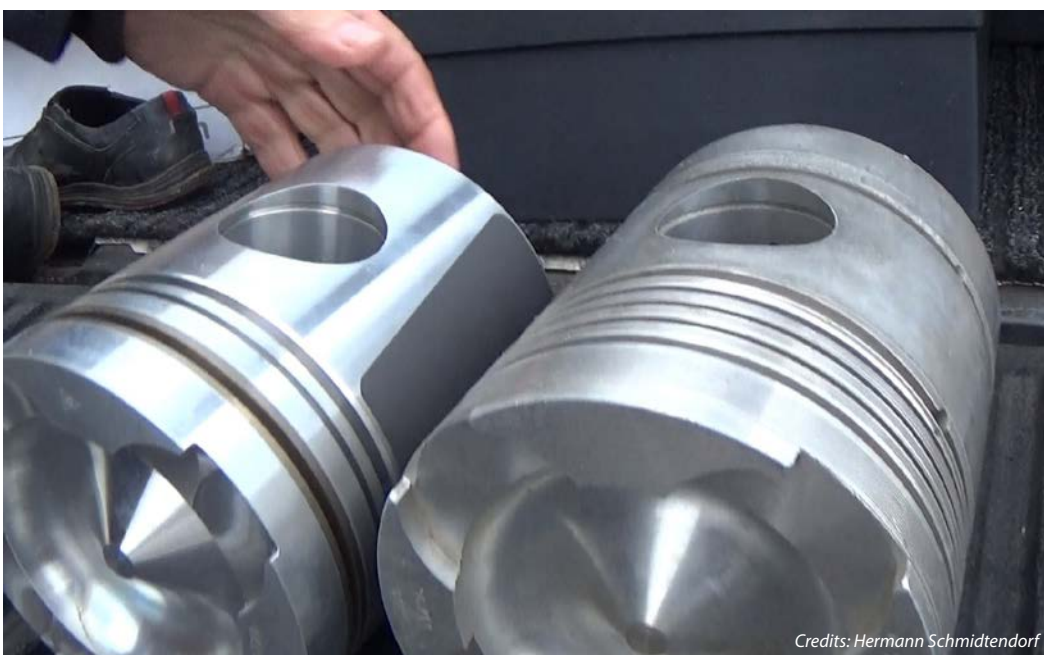
Neue Kolben aus Indien: links das verbesserte Neuprodukt, rechts das alte Original.
