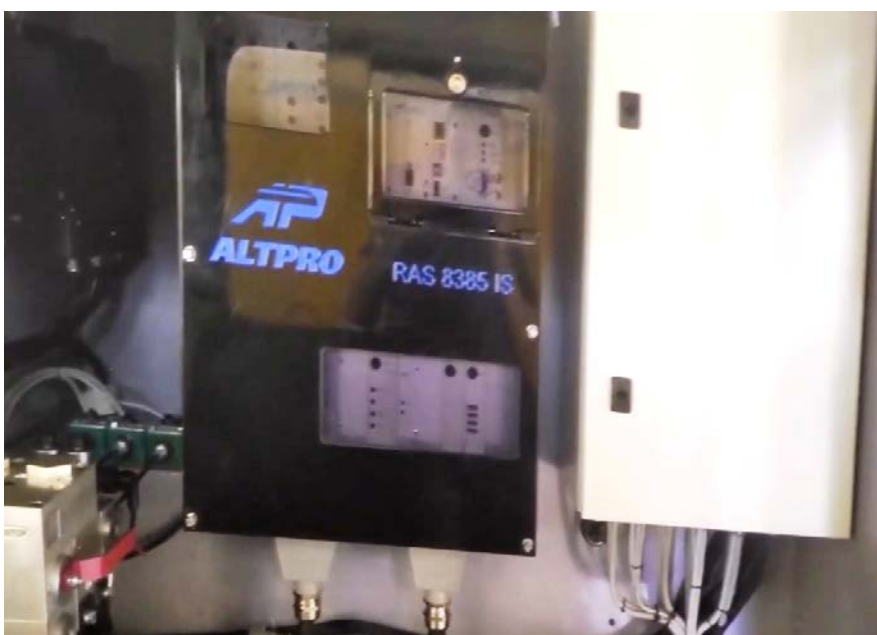
Die RAS 8385, eine Indusi 60 von Altpro. The RAS 8385, an Indusi 60 from Altpro.
